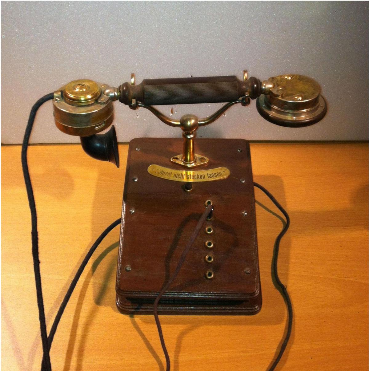
Tisch-Linienwählapparat für Batteriebetrieb mit automatischer Stöpselauslösung. (TEFAG-Katalog 1925, No. 5330/6 Capote. Tischlinienwählapparat für Normalschaltung, bestehend aus Mikrotelefon No. 5073, Induktionsspule No. 8005, vernickelter Gabelständer, mit automatischer Umschaltung, eingebauter Summer, Schnur mit Stöpsel, Anschlußschnur und Rosette für 6 Richtungen).
